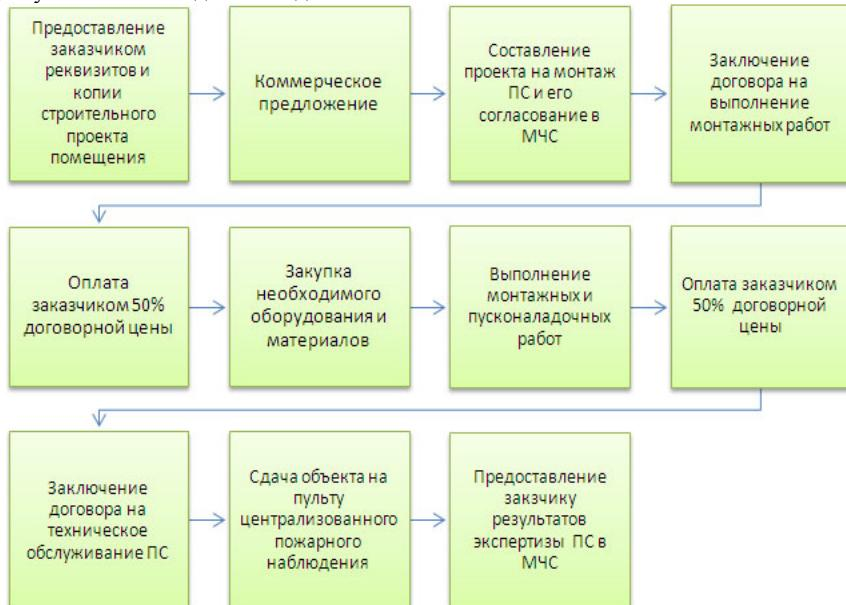
Рис. 2 – Бизнес-процесс «Монтаж пожарных сигнализаций»
